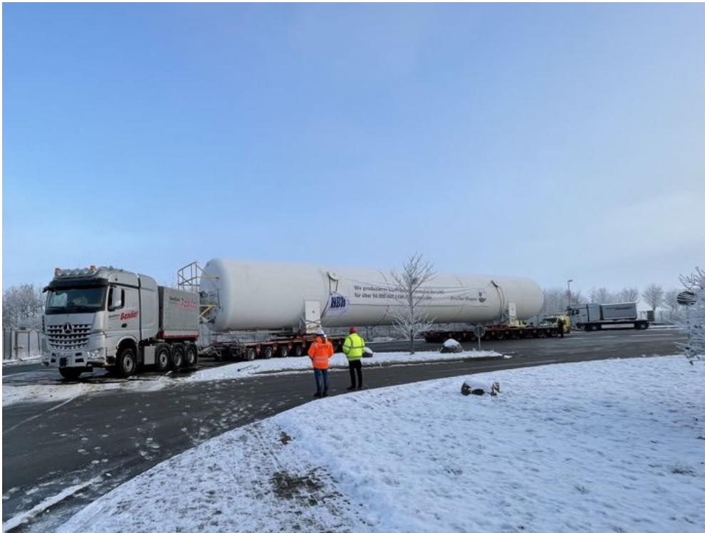
Ankunft des knapp 40 m langen LNG-Tanks auf dem Gelände des BioEnergie Park Güstrow (Foto: EnviTec Biogas AG)
